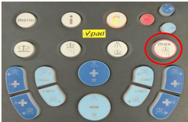
9) Salzmenge maximal für Notfälle (Brücken usw.).
