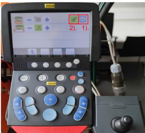
Um den Pflug abzuhängen, muss der Montage-schalter im Pflugmenu gedrückt werden. In dieser Funktion kann die Pflugplatte über die Anbauplatten vom LKW gehoben werden.
