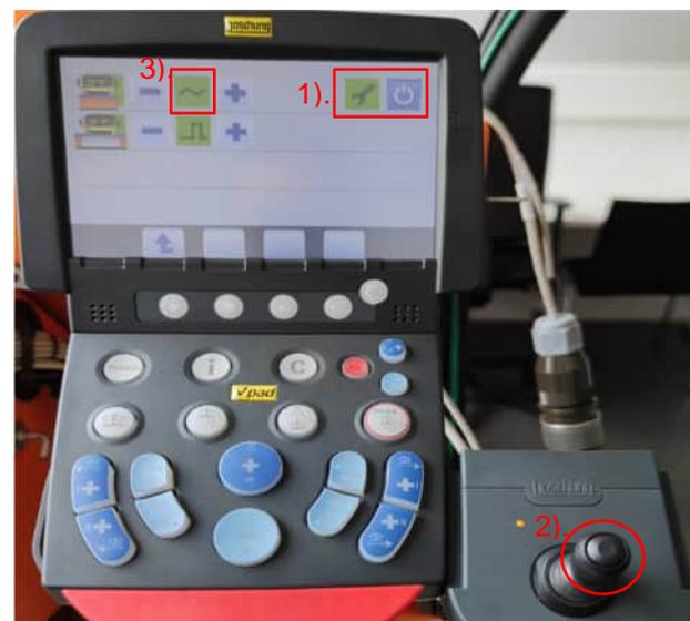
Um die Hydraulikleitungen vom LKW zu trennen, muss der Pflug auf die Schwimmstellung gestellt werden.
